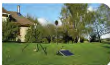
Installation des sonomètres près des habitations
